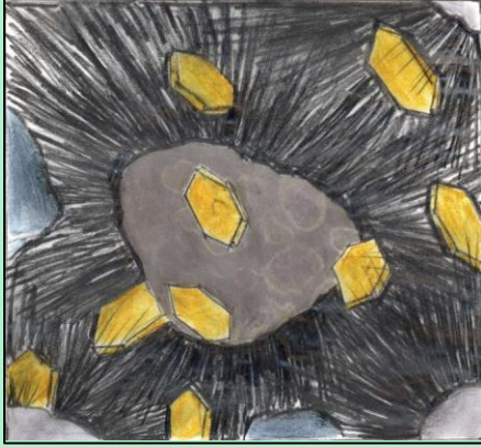
Şekil 16: Çimento ürünlerinin zamanla yoğun bir yapı oluşturması[1]
