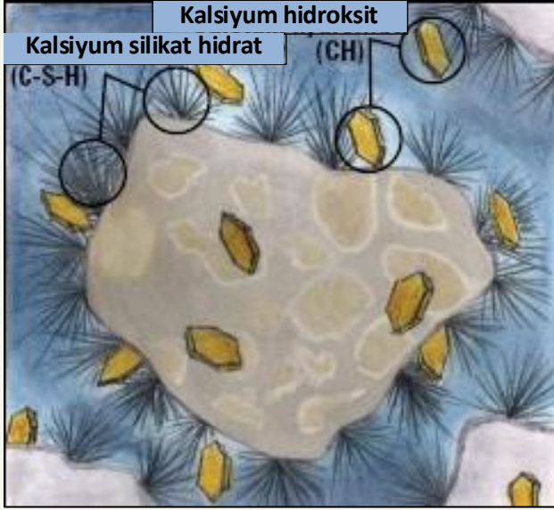
Şekil 14: C-S-H ve CH oluşumu[1]
